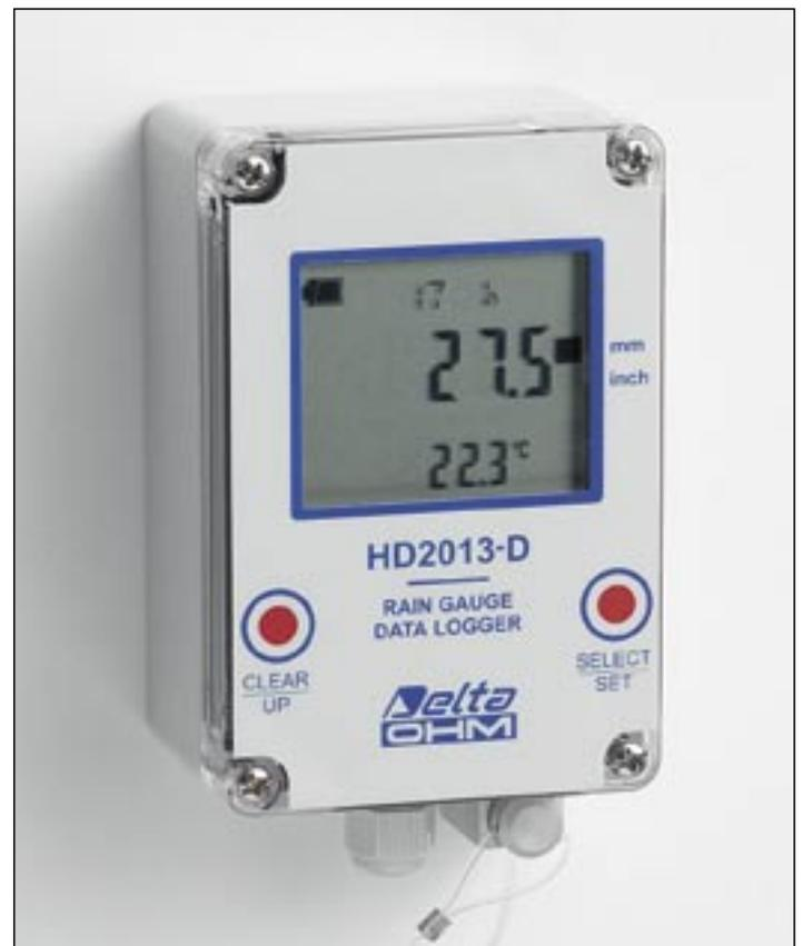
Datalogger para pluviómetro.
