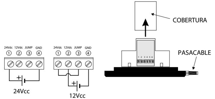
Fig. 1 Conexión eléctrica.
