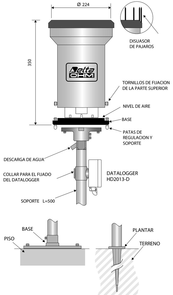
Fig. 2 Dimensiones mecánicas, sistemas de instalación.
