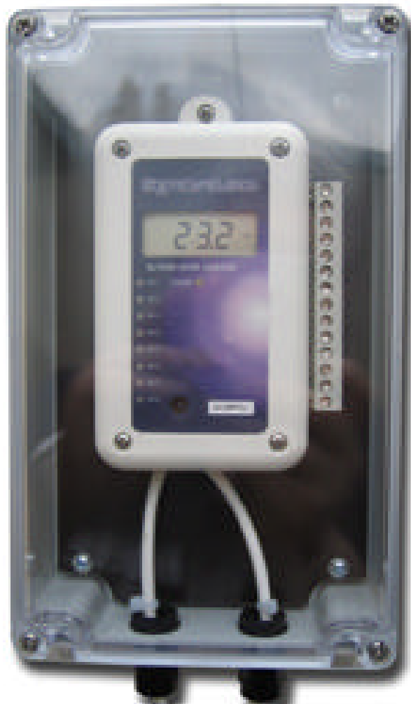
OPCION CAJA IP65: SL-ACC32 Data-logger montado en caja para intemperie con protección IP65
